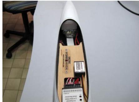
Für den Einbau einer **2,4GHz Anlage** können die **Antennen hinter der Kabinenhaube** entweder seitlich ...
