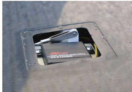
Die **Einbaurahmen** werden im Servoschacht **eingeklebt**.
