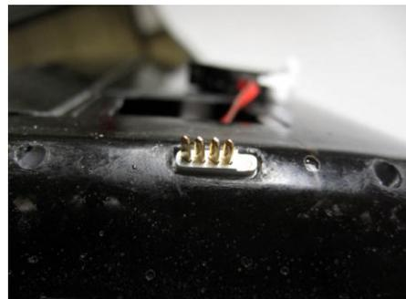
Der **Verbindungsstecker** wird in der vorbereiteten Vertiefung im Höhenleitwerk, das Gegenstück im Rumpf eingeklebt.
