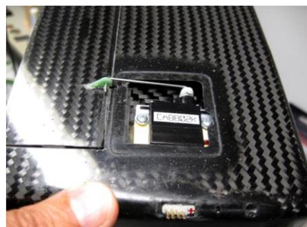
Die **Anlenkung** erfolgt mit den beiliegenden **Anlenkhebeln** und **Stahldraht**.
