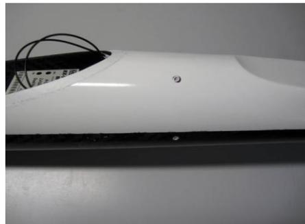
.... oder beide oben aus dem Rumpf geführt werden. In jedem Fall sollten die beiden Antennen einen **Winkel von 90°** zueinander einnehmen.
