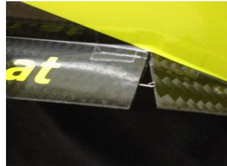
Alternativ kann an der Endleiste ein Stück Stahldraht mit Klebeband befestigt werden, das an einem Ruder fest geklebt ist und am anderen Ruder innerhalb des Klebestreifens beweglich ist.
