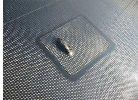
Als **Mitnehmer** für die **äußeren Querruderenden** (Dreiecke) kann man einen **0,8 mm Stahldraht** (oder dünner) in die Querruderklappe einkleben.
