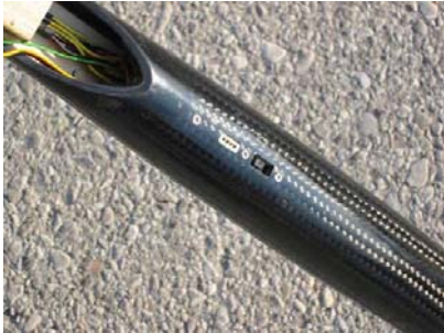
Fertig montierter Schalter und Buchsen an der Rumpfaussenseite
