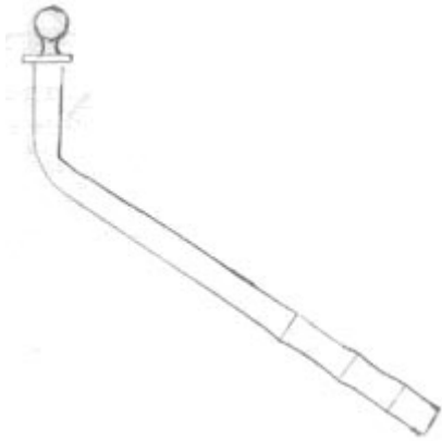
Aluhebel Maßstab 1:1 als Biegevorlage
