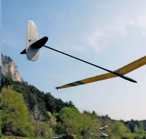
Mit zwei Metern Spannweite stellt der „FireworXtend“ eine perfekte Kombination handlicher Modellgröße und hoher Thermikleistung dar. Der lange Leitwerksträger, der im liegenden Querschnitt an ein Schwert erinnert, besteht aus hochmodularer Kohle.
