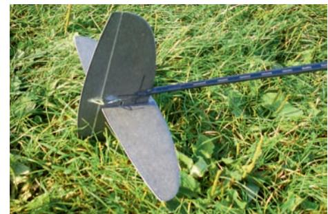
Der vollständige Kleinteilesatz inklusive des notwendigen Ballasts ist perfekt! · Mit dem RC Einbau ist das Rumpfvorderteil gut gefüllt, aber man kommt ohne Trimmblei aus · Das Leitwerk ist ein „echtes“ Kreuzleitwerk. Das Höhenleitwerk ist als Pendelruder ausgelegt.
