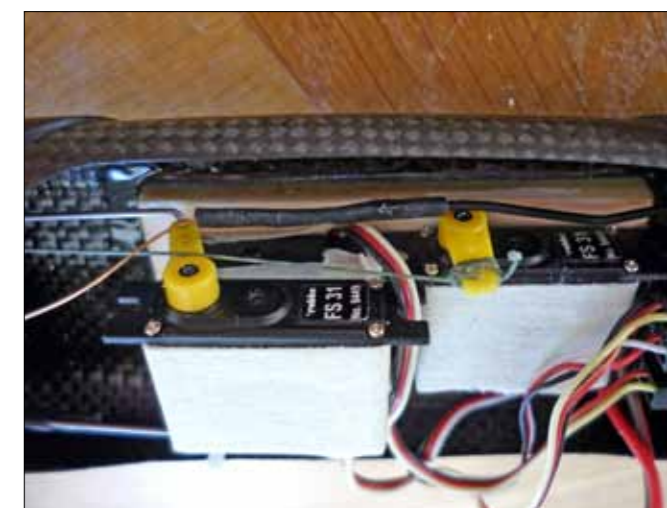
Die drei Servos der 5-Gramm-Klasse: Einfach in Tesakrepp wickeln und mit Sekundenkleber auf das kleine Stück Pappelsperholz kleben – das hält sicher!
