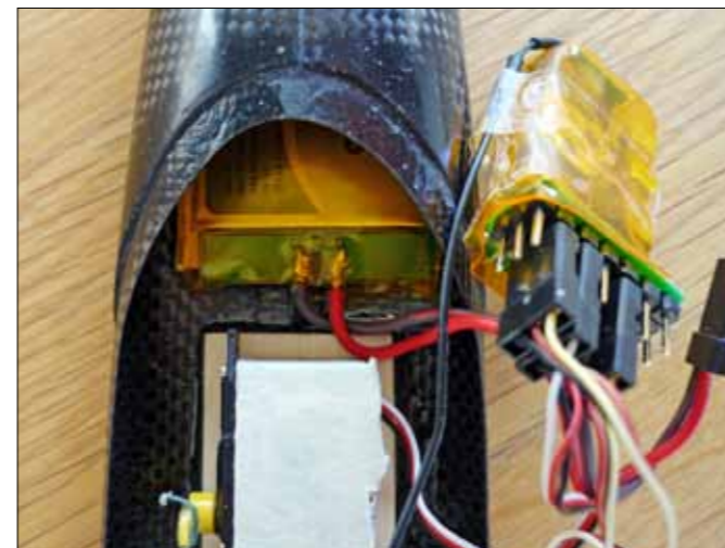
Die Rumpfnase des »Ultralight«: Unter dem geschrumpften SMC 16 liegt die 350er-Kokam-Zelle. Dieser 10 g leichte Energieriegel taugt für zwei bis drei Stunden Flugvergnügen
