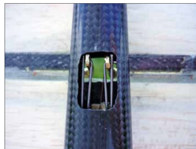
Die etwas knifflige Anlenkung der Querruder. Was im Foto so groß wirkt, ist nur ein Stück 0,8er-Stahldraht, der mit Schrumpfschlauch an einem 2-mm-Kohleröhrchen klebt
