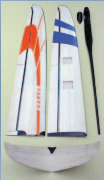
Rumpf, Flächen und Leitwerke sind im Lieferzustand fertig aufgebaut. RC-Komponenten und Motor müssen noch eingebaut werden.
