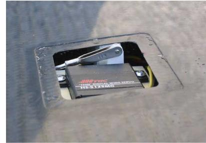
Für den leichteren Ein- und Ausbau der Servos kann man sich eine Halterung aus Sperrholz bauen.
