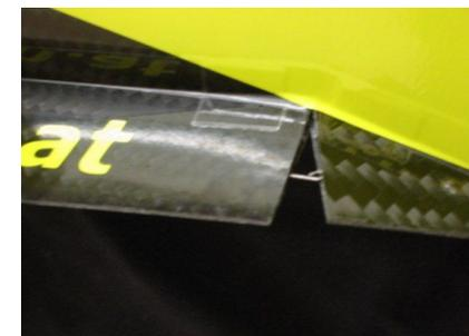
Alternativ kann an der Endleiste ein Stück Stahldraht mit Klebeband befestigt werden, das an einem Ruder fest geklebt ist und am anderen Ruder innerhalb des Klebestreifens beweglich ist.
