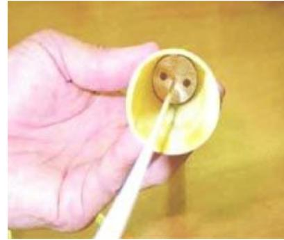
Nun sollte die Ausrichtung des Leitwerkes um die Rumpfachse kontrolliert werden, damit das Leitwerk auch symmetrisch auf dem Rumpf sitzt.
