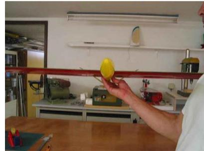
Verschwinden die beiden Spitzen gleichzeitig, ist das Leitwerk richtig ausgerichtet.
