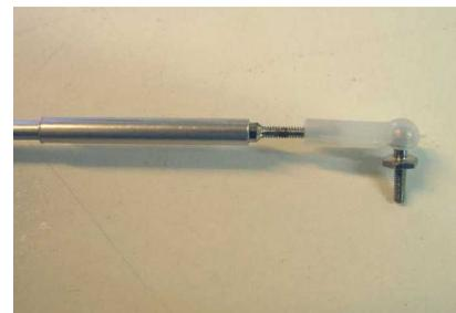
Fertig montierte Anlenkung
