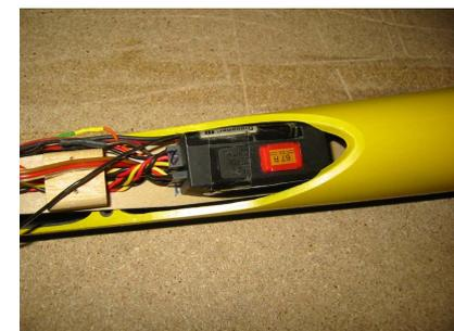
Um den Flieger im aufgebauten Zustand einfach bedienen zu können, schlagen wir vor, Schalter, Ladebuchse und Scanbuchse auf einem kleinen Brettchen zu montieren.
