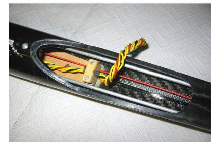
Der Empfänger sollte nahe der Rumpfföffnung sitzen, sodass ein leichter Quarzwechsel möglich ist.
