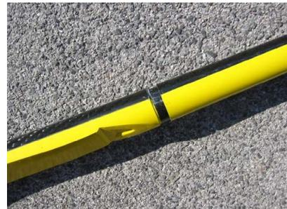
Dazu werden die beiden Rumpfteile ineinandergesteckt und auf einer ebenen Unterlage aufgelegt. An der Rumpfteilung wird ein Abstandhalter mit 11mm Höhe untergelegt.
