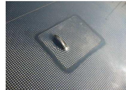
Als Mitnehmer für die äußeren Querruderenden (Dreiecke) kann man einen 1 mm Stahldraht in die Querruderklappe einkleben.
