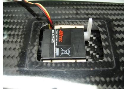
Z.B. aus zwei Sperrholzteilen für Servo Hitec HS-125MG ...
