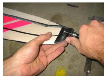
Créez maintenant une ouverture dans l'aile avec une mini perceuse ou une fraise.
