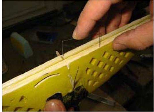
Insérer le ressort dans le balsa puis le durcir avec quelques gouttes de colle cyanoacrylate
