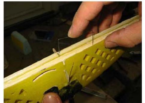
Insérez le ressort dans le balsa puis le durcir avec de la colle cyanoacrylate.
