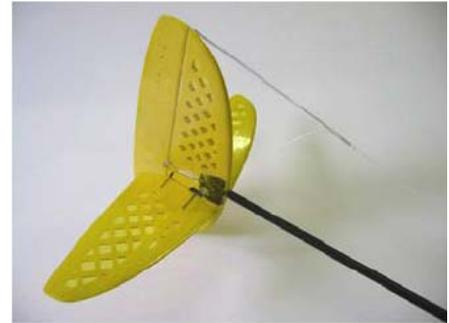
Une autre solution consiste à faire courir l'antenne dans la saignée de l'aileron opposé au saumon de lancé. Pour améliorer la réception dans le cas des ailes carbonées, vous pouvez souder une CAP de 0,3mm que vous fixerez en bout d'aile en veillant à avoir 10-15cm hors de l'aile.
