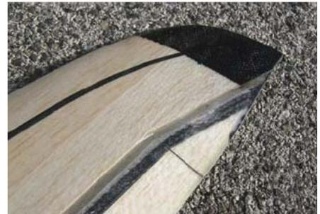
Comme il est très difficile de voir un dommage sur le bord d'attaque de l'aile (par exemple après un atterrissage dur), nous vous conseillons de coller une bande de ruban adhésif sur le bord d'attaque.
