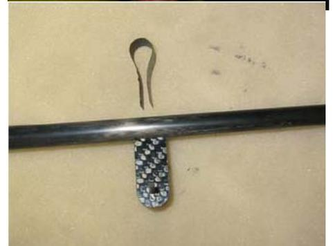
Insérez le support aussi profond que possible dans le tube de queue.
