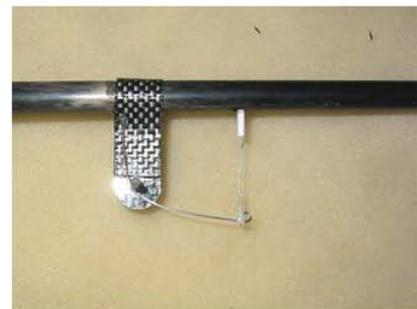
Pour réaliser la jonction arrière, insérer doucement la tige carbone dans le balsa. Durcir les trous créés avec de la colle cyanoacrylate et repercer les trous.
