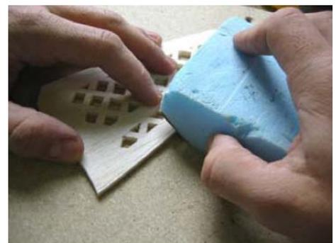
Lorsque le ponçage jusqu'à la ligne est réalisé sur les deux faces, vous pourrez continuer avec la ligne suivante.
