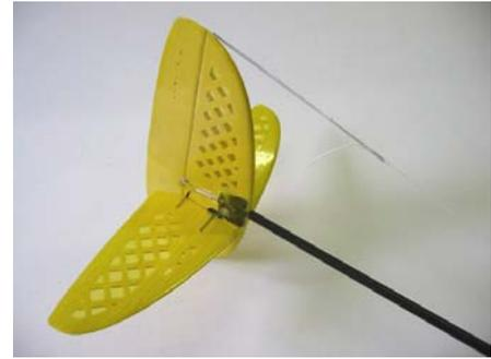
Eine andere Möglichkeit ist, die **Antenne im Klappenspalt** des Flügels zu verlegen. Um den Empfang bei **Kohle-Flächen** zu verbessern, kann am Flügelende ein **Stahldraht**  $d=0,3\text{mm}$  ca. 10-15cm weit aus der Tragfläche herausgeführt werden, an dem die Antenne angelötet wird.
