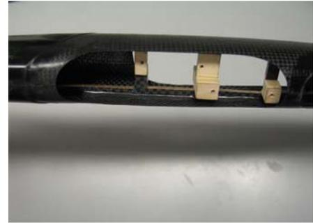
Das Servobrett kann mit einem Tropfen Sekundenkleber im Rumpf für den Testlauf angeheftet werden.
