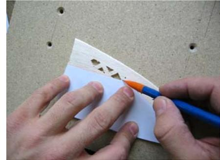
An der **Endleiste** wird die **Mittellinie** angezeichnet.
