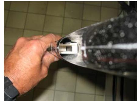
Der Schacht wird in dieser Position **mit Sekundenkleber** fixiert. Vorher werden die Klebestellen gut aufgeschliffen.
