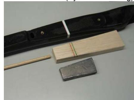
Der Schacht wird so in den Rumpf eingeschoben, dass er **seitlich an der Rumpfwand** und **oben an den Verschraubungshülsen** für die Tragfläche anliegt.
