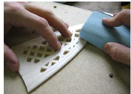
Da der Schleifwinkel an der dritten Linie so flach ist, kann hier **auch ohne Winkel-Schleifklotz** mit Gefühl gearbeitet werden.
