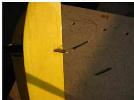
Das Schlaufenende wird verdreht, in einen **Schrumpfschlauch** gesteckt, geschrumpft und mit **Sekundenkleber gesichert**.
