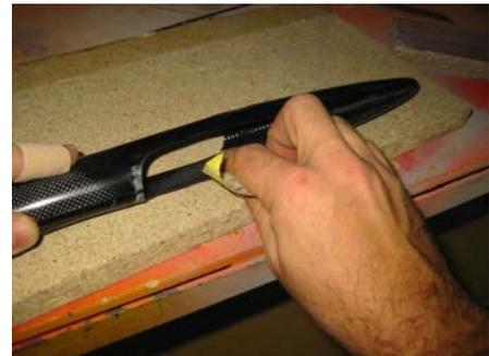
Das Servobrett muss mit **Epoxy-Kleber** (z.B. UHU 300 endfest oder Pattex Stabilit) kraftschlüssig verklebt werden.
