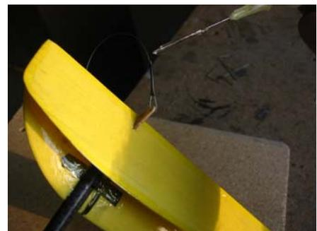
Nun müssen noch **Durchgangslöcher im Rumpf** gebohrt werden, um das Anlenkseil innerhalb des Rumpfs bis zu den Servos führen zu können.
