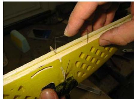
Die **Feder** wird ins **Balsamaterial** gesteckt, das Balsa dann mit **Sekundenkleber** gehärtet.
