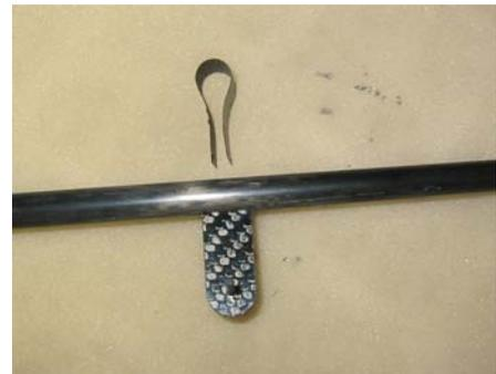
Der Höhenleitwerks-Träger wird **bis zum Anschlag ins Rohr gesteckt**.
