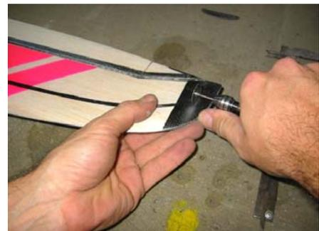
Dann wird mit einer kleinen Trennscheibe und/oder einem kleinen Fräser die **entsprechende Öffnung in die Tragfläche geschnitten**.
