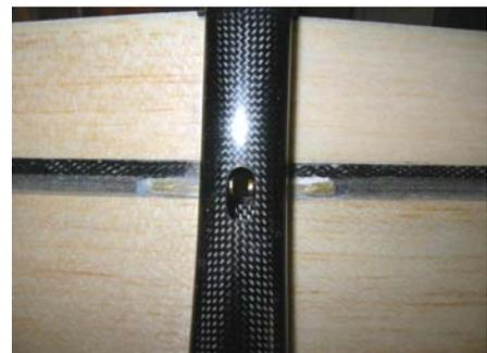
Ans Ende der Kohle-Schubstangen werden **Häken aus 0,8mm Stahldraht** geklebt, die **gegen Aushängen** sichern.
