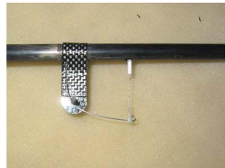
Die hintere Steckung wird durch **Eindrücken der Stabes** ins Balsa erzeugt. Die so entstandenen Löcher werden anschließend **mit Sekundenkleber gut und großflächig gehärtet** und danach mit dem Bohrer **nochmals aufgerieben**.
