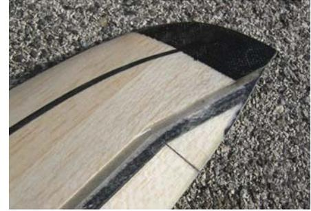
Eine einfachere Lösung ist die Verbindung der Ruder mit **Klebestreifen** (siehe Bild).
