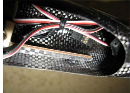
Bevor das Servobrett in den Rumpf geklebt wird, müssen die Klebestellen im Rumpf gut aufgeschliffen werden.
