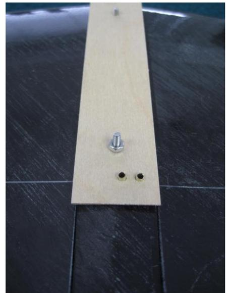
Falls die **Freistellung für die Messingrohre** am Flügel noch nicht ausreichend vorhanden ist sollte sie laut Bild erweitert werden.
