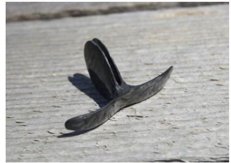
Die Klebeflächen auf der Tragfläche und am Stift werden **gut aufgeschliffen** und vom Schleifstaub befreit. Anschließend wird der Wurfstift **mit einem Epoxidkleber befestigt**.
