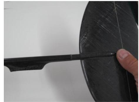
Es hat sich bewährt, das gesamte Modell **in Rückenlage** auf eine möglichst **gerade Oberfläche** zu legen und dann das Seitenleitwerk dazu mit einem Winkel einzurichten.
