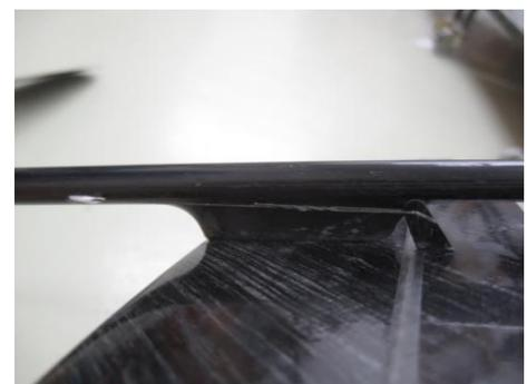
Wer es besonders schön machen will, kann das Seil auch aus dem Pylon führen und den Hebel direkt dahinter anlenken. Dazu muss der Hebel aber ein wenig abgeschliffen werden.
