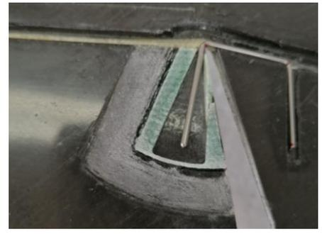
Es wird reichlich Sekundenkleber aufgebracht. Mit Hilfe einer Pinzette kann das Kohleplättchen exakt aufgelegt werden.
