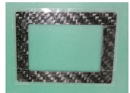
Klebe den Rahmen nun auf die Latexfolie. Wir liefern die Latexfolie doppelt so groß aus, damit du eine in Reserve hast. Schneide also sparsam aus. Der entstandene Teil wird nun mit der Latexfolie nach außen in die Vertiefung im Flügel gelegt und mit Klebeband fixiert.
