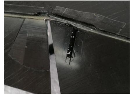
Nach dem Aushärten des Epoxidharzes muss man die Ruderstellung kontrollieren. Wenn das Querruder in Nullstellung ist (das sieht man am innersten Ruderschnitt) muss auch das Zusatzruder (sieht man am äußersten Ruderschnitt) in Nullstellung sein. Falls das nicht der Fall ist, fasst man die Ruder, an den Stellen wo der Stahl eingeklebt ist fest an und verdreht den Stahl in die gewünschte Richtung.
