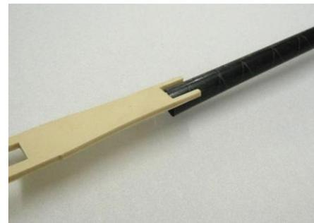
Vor dem Verkleben des Rohrs muss überprüft werden, ob das **Servobrett** später lt. Bild **an das Rohr** angeklebt werden kann. Die flache Seite des Rohres soll nach oben zeigen, die runde nach unten.
