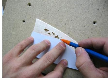
Mit einem normalen Schleifklotz wird solange geschliffen, bis sich eine **Ebene** zwischen der vorderen Linie und Linie an der Endleiste ergibt.
