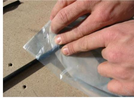
Ein **weiterer Roving in Verlängerung der Rumpfachse** dient der zusätzlichen Verstärkung.
