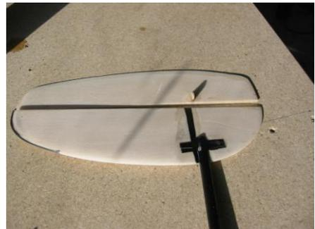
Als nächstes wird der **Ruderhebel** in Verlängerung der Rumpfachse aufgeklebt, sodass das **Loch des Hebels** genau **über der Scharnierlinie** liegt. (Mini-S)
