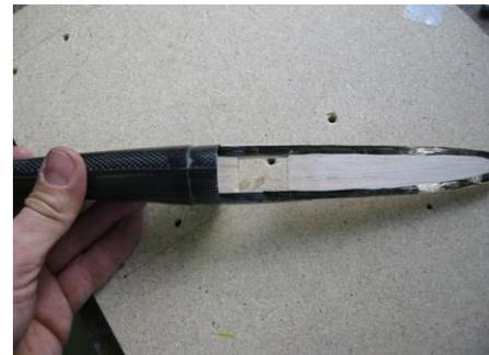
Um die volle Festigkeit des Rumpfes zu erlangen, ist der **kraftschlüssige Einbau des Servobretts unbedingt notwendig**.
