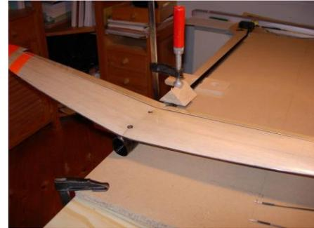
Das **Rohr** muss außerdem **auf dem Boden des Rumpfs angeklebt** werden.
