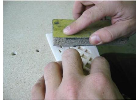
Zuletzt werden die entstandenen **Kanten verschliffen**, bis sich ein gleichmäßiges Profil ergibt.
