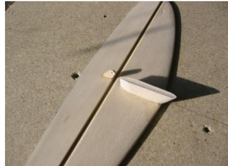
Der Pylon wird zuerst im Höhenleitwerk mit Sekundenkleber eingeklebt, dann am Rumpffrohr befestigt:
