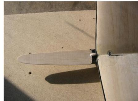
Nach einer harten Landung muss die Verklebung des Bretts im Rumpf überprüft werden!
