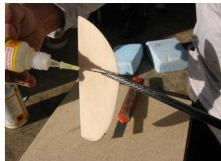
Nun wird die **korrekte Ausrichtungen** um alle Achsen kontrolliert und gegebenenfalls korrigiert. Wenn das Leitwerk exakt sitzt, wird es mit Sekundenkleber bzw. UHU 300 endfest fest verklebt.
