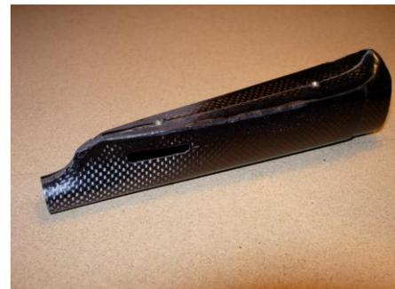
Das Rohr wird in den Mittelteil des Rumpfs soweit eingeschoben, dass das **Rohr aus dem Rumpf 530mm** heraussteht. Damit das Rohr weit genug rausgeschoben werden kann, kann an der Innenseite des Rumpfmittelteils Material weggeschliffen werden.
