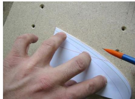
Die Linien werden **jeweils auf Ober- und Unterseite** angezeichnet. Der Schleifklotz wird am Tisch aufgelegt. Dann wird solange entlang der Linie geschliffen, **bis man an die angezeichnete Linie stößt**.
