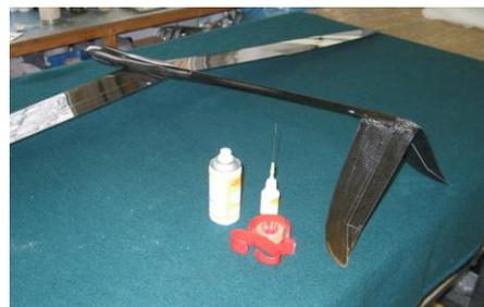
Die Klebestellen auf Rumpfrohr und Leitwerk, müssen **gut auf geschliffen** werden.
