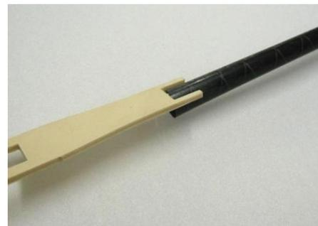
Vor dem Verkleben des Rohrs muss überprüft werden, ob das **Servobrett** später lt. Bild **an das Rohr** angeklebt werden kann. Die flache Seite des Rohre soll nach oben zeigen, die runde nach unten.
