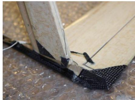
Diese Stelle wird dann mit **Sekundenkleber** gehärtet.
