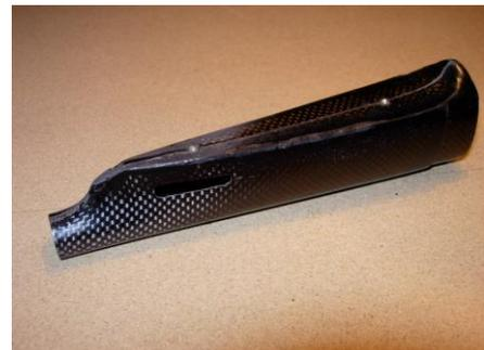
Das Rohr wird in den Mittelteil des Rumpfs soweit eingeschoben, dass das **Rohr** aus dem Rumpf **400mm** heraussteht. Damit das Rohr weit genug rausgeschoben werden kann, kann an der Innenseite des Rumpfmittelteils Material weggeschliffen werden.
