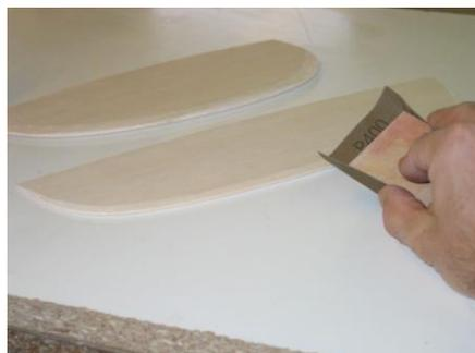
Die Kanten werden mit feinem Schleifpapier (z.B. **Körnung 400**) **verschliffen**.
