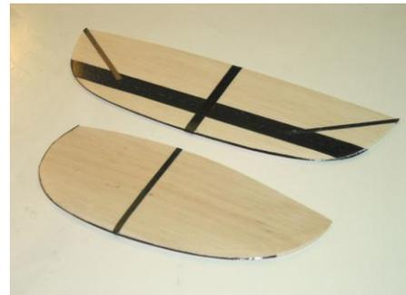
Die Balsateile müssen danach **2x mit Porenfüller** bestrichen und anschließend **geschliffen** werden. Dadurch erhalten sie einen dünnen, leichten Schutzfilm.
