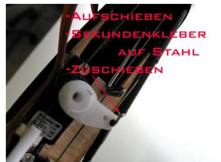
Auf der Servo-Seite wird der Haken nach dem Eintrimmen mit eingeschalteter Fernsteuerung mit einem Tropfen **Sekundenkleber in der richtigen Position** am Kohlestab fixiert.
