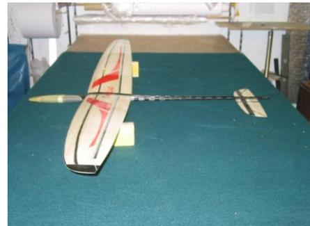
Die **EWD** ist durch korrektes Ablängen der Rohre richtig eingestellt. Sie beträgt **1°**.
