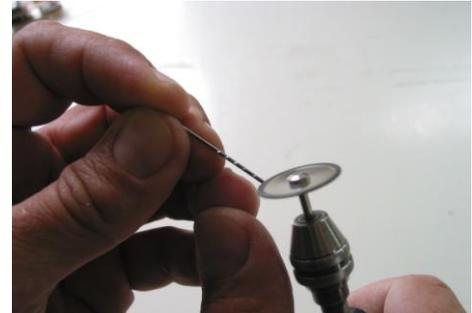
Der Haken wird zuerst **sorgfältig angeschliffen**, damit die Verklebung gut hält.
