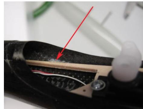
Das Servobrett muss mit **Epoxy-Kleber** (z.B. UHU 300 endfest oder Pattex Stabilit) kraftschlüssig verklebt werden. Ein guter Trick für **genaue Dosierung** ist es, den Kleber in ein Säckchen einzufüllen und eine Ecke abzuschneiden. So bekommt man einen **Dressiersack** wie ein Zuckerbäcker.
