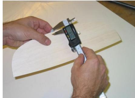
Dann wird mit dem **10°-Schleifblock bis zur Linie** geschliffen. Danach wird mit dem **30° Schleifblock** die Kante **abgefast**. Das Leitwerk sollte jeweils auf der nicht geschliffenen Fläche plan am Tisch aufliegen.
