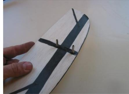
Nun werden die **5mm** Rohre abgelängt: **24,5mm (vorne)** **23,5mm (hinten)**. Die **Spreizhülsen** werden in das Rohr **eingepresst**. Das **Gewinde** sollte dann nachgeschnitten werden, da es durch das Einpressen etwas kleiner wird.
