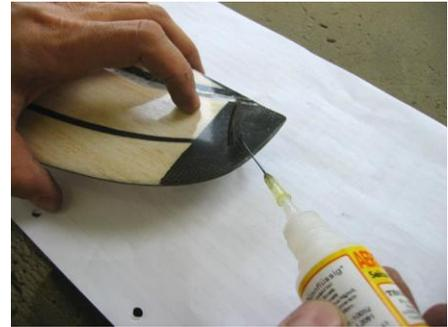
Wenn die Position passt, wird das Wurfblade **mit Sekundenkleber fixiert**.
