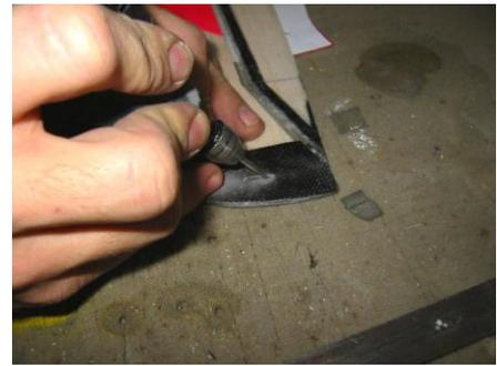
Wenn der Schnitt groß genug ist, kann das **Blade durchgesteckt** werden. Nun wird es in allen Achsen **korrekt ausgerichtet**. (siehe oben)
