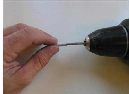
Nun kann die **Position der Alurohre** auf den Rumpf übertragen werden. Es wird alles „trocken“ zusammengesteckt und die richtige **Ausrichtung überprüft**. Dann können die 5mm Rohre mit dünnflüssigem Sekundenkleber fixiert werden.
