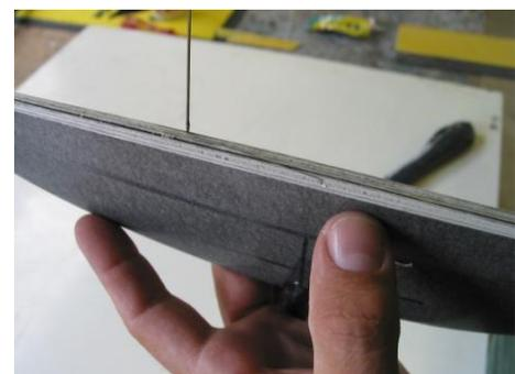
Das **Leitwerk** wird (zunächst probeweise) **bis zum Anschlag** in das ovale Rumpfrohr gesteckt. Dann kontrolliert man die **Ausrichtung des Seitenleitwerks** und **des Höhenleitwerks** zum Rumpf **nach allen Achsen**.
