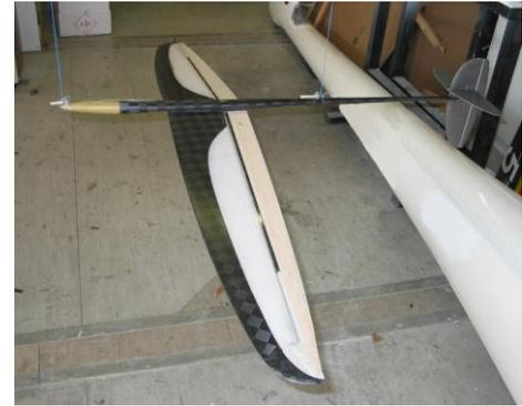
Um die Massenzentrierung in Zahlen fassen zu können, schlägt **Mark Drela** folgenden **Schwingversuch** vor: Man hängt sein Modell auf 1,5m lange Schnüre, die jeweils 30cm vom Schwerpunkt entfernt sind auf und lenkt das Modell um 45° aus. Dann stoppt man die Dauer von 5 Schwingungen. Diesen Versuch sollte man mindestens 5 mal wiederholen und dann einen Mittelwert ermitteln. Je schneller das Modell schwingt, desto schneller wird es sich nach dem Wurf stabilisieren und umso höher wird es starten.
