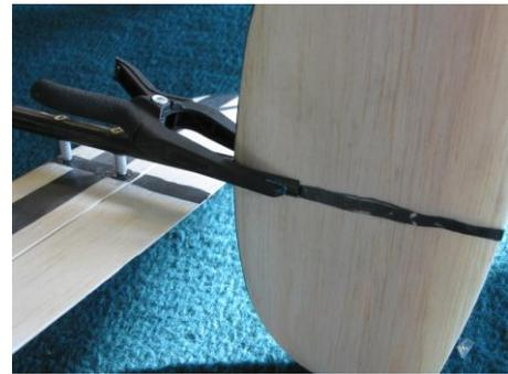
Die Klebestelle zwischen Rumpfrohr und Seitenleitwerk sollte man noch zusätzlich **mit einem dünnen Roving und dünflüssigem Sekundenkleber** verstärken.
