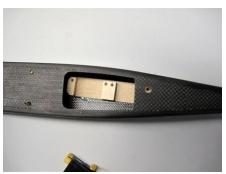
Das Anschlusskabel aus der Fläche wird direkt an den Empfänger angesteckt.
