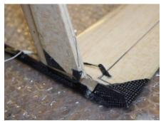
Diese Stelle wird dann mit Sekundenkleber gehärtet.
