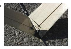
Das Leitwerk wird nun auf das Rohr aufgesetzt und dort verklebt. Vor der Verklebung sollte die **Ausrichtung des Leitwerkes um die Rumpfachse** sowie **die EWD** kontrolliert werden, damit das Leitwerk auch korrekt auf dem Rumpf sitzt.
