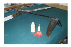
Die **EWD** (Winkel zwischen Tragfläche und Höhenleitwerk) soll **1,8°** betragen. Die Teile sind so vorgefertigt, dass sich der Winkel automatisch ergibt. Trotzdem sollte das genaue Maß überprüft werden. Die Einstellung der EWD kann gemäß nachstehender Zeichnung erfolgen.
