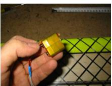
Das **Servo** wird mit Stabilit Express oder 5min-Epoxy **eingeklebt**. Für die **Schubstange** wird ein **1mm-Stahldraht** It. Bild mit einer variablen Verbindungsstelle (z.B. Kohlerohr) vorbereitet.
