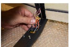
Nach einer harten Landung muss die Verklebung des Motorspants im Rumpf sowie alle Bauteile auf ihre Funktionstauglichkeit überprüft werden!
