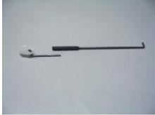
Nun wird ein **Loch** in die Schale als Verbindung zum Anlenkhebel gebohrt und mit einem **Überschubrohr** versehen.
