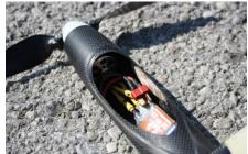
Die weitere Empfangsanlage (2 Servos, Empfänger) liegt im hinteren Rumpfbereich.
