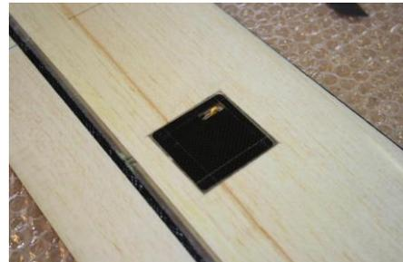
Um den **Verbindungsstecker** verschwinden zu lassen, fräst man einen entsprechenden **Schlitz ins Balsa**. Das entsprechende Gegenstück ist im Rumpf einzukleben.
