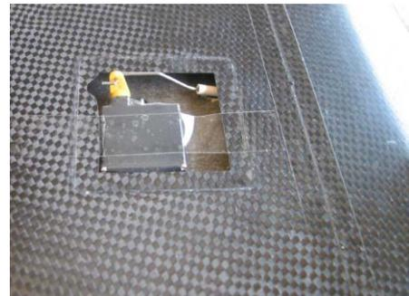
Das **Servo** wird mit Stabilit Express oder 5min-Epoxy **eingeklebt**. Für die **Schubstange** wird ein **1mm-Stahldraht** lt. Bild mit einer variablen Verbindungsstelle (z.B. Kohlerohr) vorbereitet.
