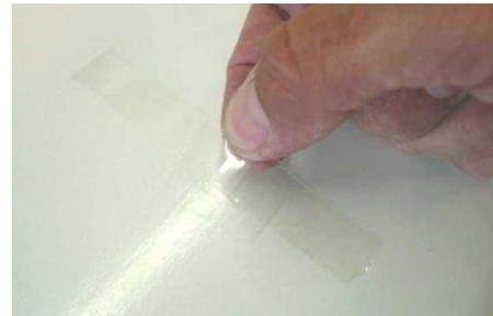
Dazu werden Leitwerk und Tragfläche am Rumpf montiert. Das **Leitwerk wird mit Klebeband am Rumpfrohr angeheftet**. Am besten verwendet man dazu einen Klebestreifen, in dessen Mitte die klebrige Seite mit einem weiteren Stück Klebestreifen nicht klebend gemacht wird. Auf diese Weise lässt sich das Leitwerk noch bewegen.
