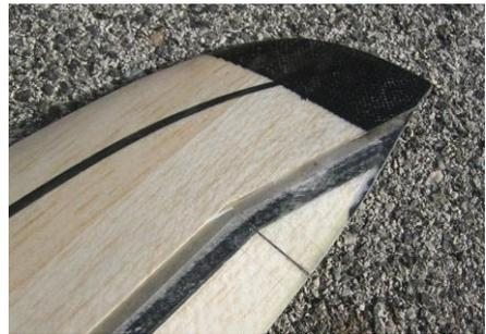
Eine einfachere Lösung ist die Verbindung der Ruder mit **Klebestreifen** (siehe Bild).
