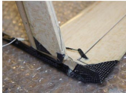
Diese Stelle wird dann mit **Sekundenkleber** gehärtet.
