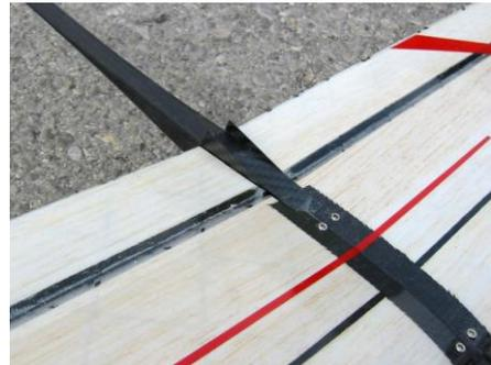
Als Mitnehmer für die äußeren Querruder-Enden (Dreiecke) kann man einen **1 mm Stahldraht** in die Querruderklappe einkleben.
