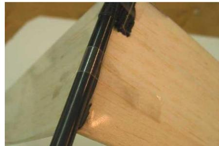
Dann schaut man von vorne auf das Modell und senkt langsam das Heck ab, bis die Spitzen des Leitwerks hinter der Nasenleiste verschwinden. Verschwinden die beiden Spitzen gleichzeitig, ist das Leitwerk **symmetrisch ausgerichtet**.
