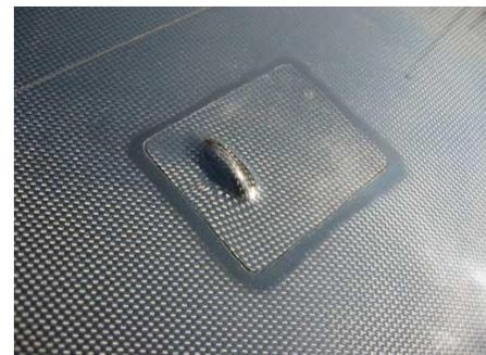
Um die **äußeren Querruderenden** (Dreiecke) mit der Bewegung der Querruderer mitzuführen, verbindet man einfach beide Ruder mit einem Klebestreifen.
