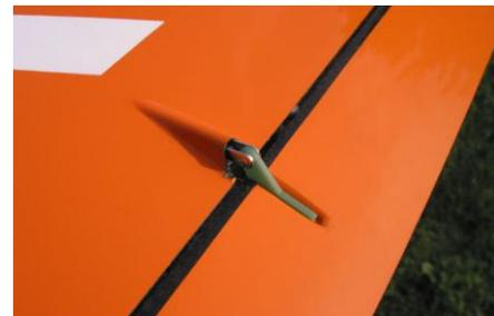
Der Hebel wird mit **UHU 300 endfest** (vorzugsweise mit Baumwollflocken eingedickt) großzügig eingeklebt.
