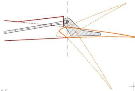
Als Verbinder der beiden Gabelköpfe dient ein **Schweißdraht d=2mm**. Der Schweißdraht wird **in den beiden Gabelköpfen verlötet**.
