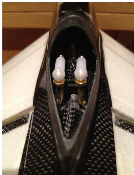
Fertig montierte Anlenkung (hier am Beispiel des Erwin XL ultralight)
