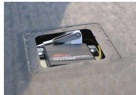
Die vorgefertigten **Schlitz**e für die Hebel müssen vor der Verklebung **aufgeschliffen** werden.
