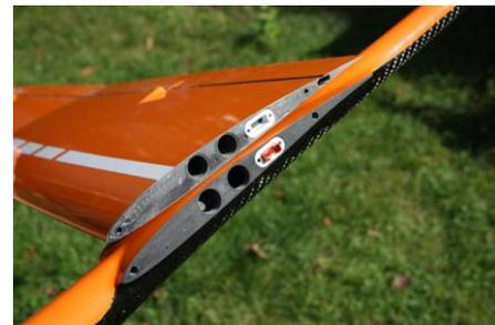
Die **Servoabdeckungen** werden mit dünnem Doppelklebeband angeklebt.
