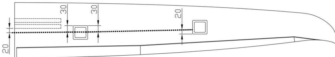
Die Anlenkung erfolgt **quer durch die Tragfläche** zum Anlenkhebel im Ruder.
