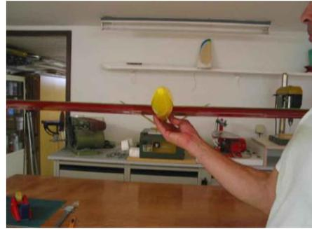
Sitzt das Leitwerk schief, kann man die **Kanten der Rumpfsteckung** am Rumpfvorderteil **leicht abfasen**, sodass das Rumpfrohr gedreht werden kann, bis das Leitwerk symmetrisch sitzt.
