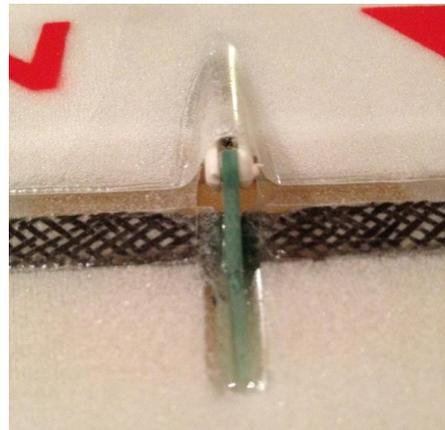
Der Hebel wird mit **UHU 300 endfest** (vorzugsweise mit Baumwollflocken eingedickt) großzügig eingeklebt.
