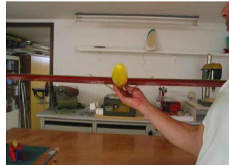
Sitzt das Leitwerk schief, kann man die **Kanten der Rumpfsteckung** am Rumpfvorderteil **leicht abfasen**, sodass das Rumpfrohr gedreht werden kann, bis das Leitwerk symmetrisch sitzt.
