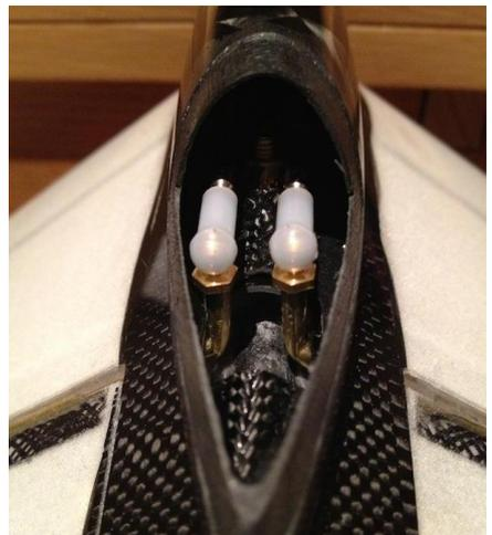
Zur Versteifung des Bowdenzuginnenrohrs sollte ein 0,8mm Stahldraht ins Innere eingeklebt werden. Dies empfiehlt sich v.a. an den Enden, wo das Innenrohr nicht mehr im Außenrohr geführt wird.
