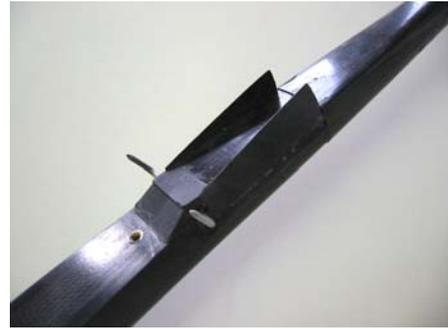
Fertig montierte Grenzzäune am Firewor-X-tend.
