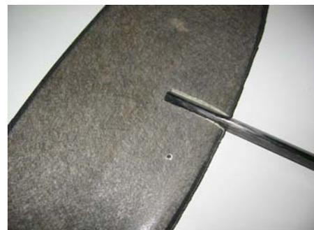
Der Teil des Rohrs der im Leitwerk verschwindet und ca. 1-2cm davor müssen aufgeschliffen werden.
