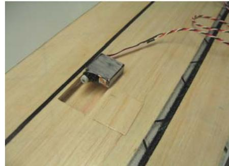
Der **Hebel** des Servos wird so weit **gekürzt**, dass er sich in der Fläche bewegen kann. Das Servo wird in einem **Schrumpfschlauch** verpackt, damit es später wieder ausgebaut werden kann.
