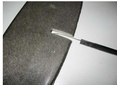
Vor dem Verkleben sollte die richtige **Passform** des Leitwerks am Rohr **überprüfen** werden. Die Achse des Rohrs sollte etwa im rechten Winkel zur Scharnierlinie des Ruders stehen. Der Faden darf nicht an der scharfen Kohle scheuern und muss widerstandsfrei beweglich sein.
