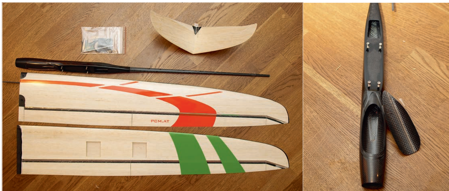
Der „Taser“ wird weit vorgefertigt geliefert · Der Rumpf ist ein Meisterwerk in CFK, zudem sehr leicht und absolut fest.
