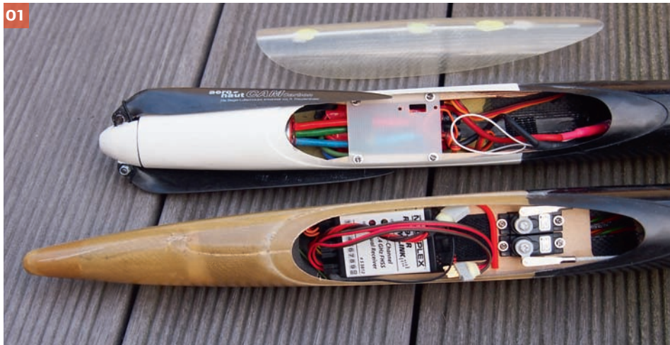
01 Der Elektro- (oben) und Seglerrumpf im Vergleich. Man sieht deutlich die leistungsoptimierte Baugröße der Rumpfe 02 Hier wird deutlich, dass die Testflüge mit den Modellen viel Freude bereiten haben
