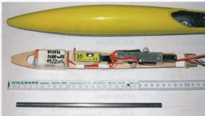
Bild links: Der Rumpfaufbau: Vier Akkuzellen Sanyo 2000 mAh NiMH, „alpha-835w“-Empfänger von Schulze, zwei „C-261“-Servos von Graupner und ein Schalter. Das Servobrett kann aus dem Rumpf genommen werden. Bild rechts: Die Wurzelrippe mit dem Ballastfach zwischen den Flächensteckungen. Die sechs Flügelstege sind weiß-durchsichernd zu erahnen. Großes Bild: „Erwin 5“ wird mit voller Landstellung sehr langsam und kann auf sehr engen Raum landen.
