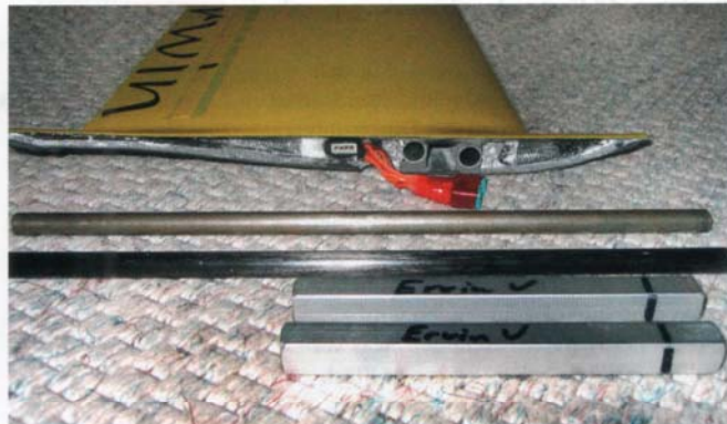
Bild links: Der Rumpfaufbau: Vier Akkuzellen Sanyo 2000 mAh NiMH, „alpha-835w“-Empfänger von Schulze, zwei „C-261“-Servos von Graupner und ein Schalter. Das Servobrett kann aus dem Rumpf genommen werden. Bild rechts: Die Wurzelrippe mit dem Ballastfach zwischen den Flächensteckungen. Die sechs Flügelstege sind weiß-durchsichernd zu erahnen. Großes Bild: „Erwin 5“ wird mit voller Landstellung sehr langsam und kann auf sehr engen Raum landen.
