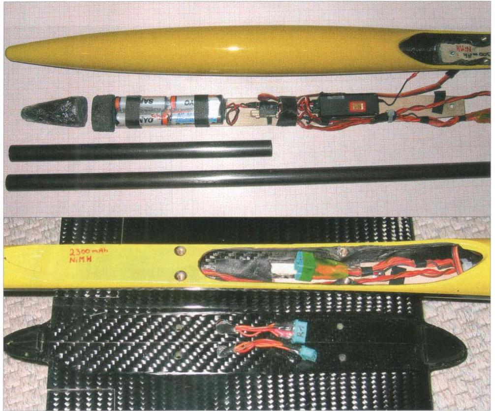
Der Rumpfausbau mit 300 g Trimmblei, vier Zellen Sanyo 2.500 mAh NiMH, Schalter und „SMC19DS“-Empfänger von Graupner. Im Vordergrund die Stahlverbinder (375 und 750 g) · Der Flügel wird beim Windenstart verschraubt und im Hangflugbetrieb mit Gewebeklebeband auf dem Rumpf befestigt. Dabei werden die Querkräfte durch den Formschluss zwischen Rumpf und Tragfläche übertragen.
