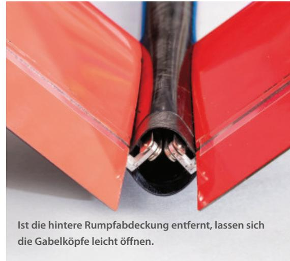
Ist die hintere Rumpfabdeckung entfernt, lassen sich die Gabelköpfe leicht öffnen.
