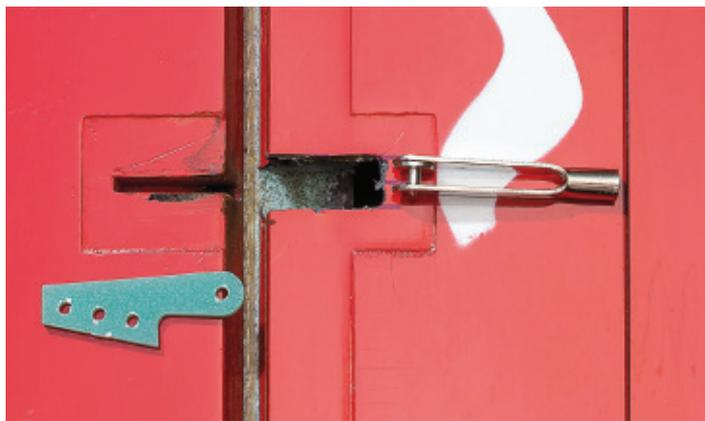
Das Ruderhorn wird mit eingeklipstem Gabelkopf eingeklebt. So kann der Durchbruch sehr schmal bleiben.
