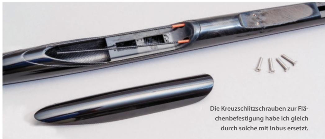
Die Kreuzschlitzschrauben zur Flächenbefestigung habe ich gleich durch solche mit Inbus ersetzt.
