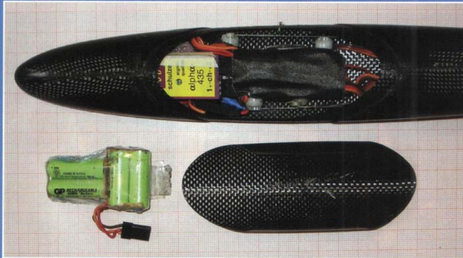
Bild links: Unter dem Schulze-Empfänger „alpha-435“, hat der Empfängerakku Platz. Die Servoanordnung und die Hebelpositionen sind gut erkennbar. Bild rechts: Die unten angeschlagenen Flaps sind aus dem Rumpffinneren heraus an gelenkt und zum Rumpf hin abgedichtet. Großes Bild: Das Kreisen in der Thermik wird durch die relativ große V-Form erleichtert. Dabei werden die Flaps leicht positiv gefahren.
