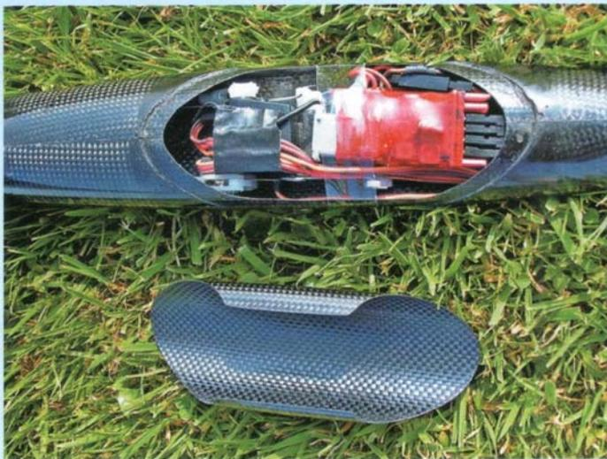
Einfach und genial: Die aus zwei Lagen Kohlefaser laminierte Kabinenhaut wird einfach auf den Rumpf geschoben und „rastet ein“. Im Rumpf wird kein Platz verschenkt.
