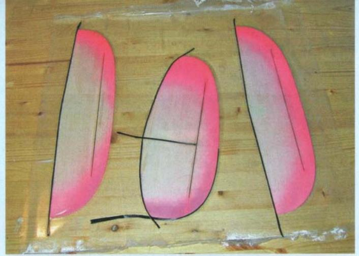
Ich modifizierte die Leitwerke. Der zweite Satz Leitwerke direkt nach dem Entformen. Gut zu erkennen sind die Kohlefaserverstärkungen und die geänderte Form des Seitenleitwerks (Bildmitte).
