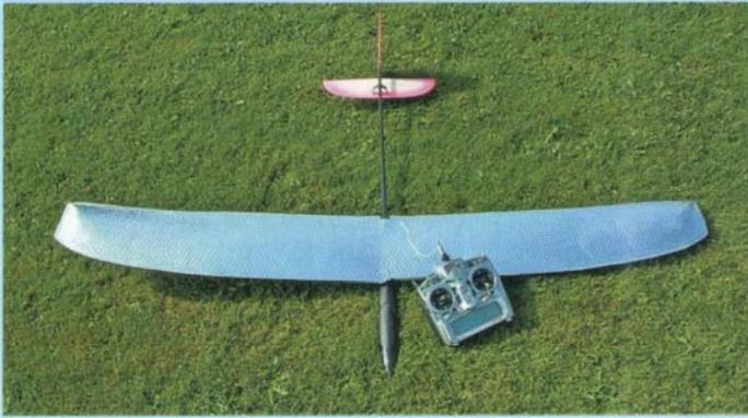
Die Flächenschutztaschen sollten erst kurz vor dem Fliegen entfernt werden, um eine Überhitzung des schwarzen Tragflügel zu vermeiden
