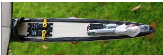
Alles in der Nasenspitze: die 145er-LiPo-Zelle, der Schulze alpha 5 und ein wenig Trimmblei ganz vorn
