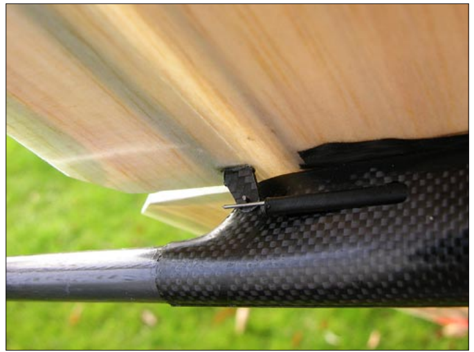
Kleiner Draht, große Wirkung: Ein Stückchen Stahldraht verhindert, dass sich die Querruderanlenkung löst
