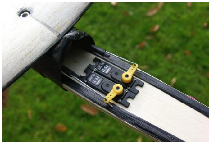
Die zwei Querruderservos. Rundum der Kohleroving, getränkt mit Sekundenkleber wird er brett hart
