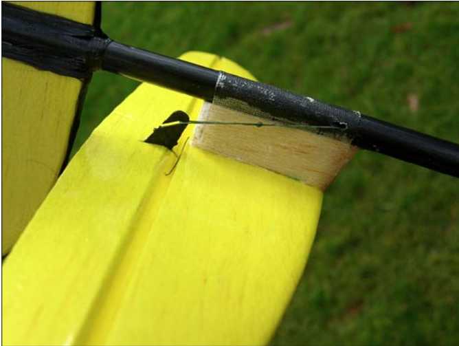
Der Balsapylon ist durch ein Stückchen Glasmatte gesichert und mit Sekundenkleber getränkt. Im Schlitz des Leitwerks ist die Feder aus 0,3er-Stahldraht gut zu erkennen. Sie baut die Spannung auf, der grüne Faden aus dem Anglerbedarf zieht dagegen
