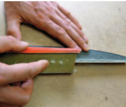
Das Seitenruder wird an einer Seite angeschlagen, dafür wird es keilförmig geschliffen.
