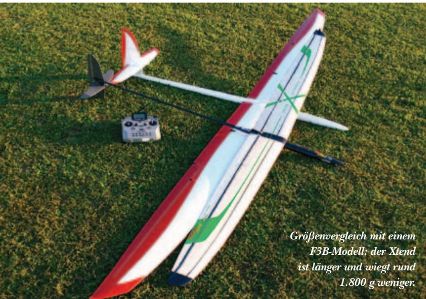
*Größenvergleich mit einem F3B-Modell: der Xtend ist länger und wiegt rund 1.800 g weniger.*
