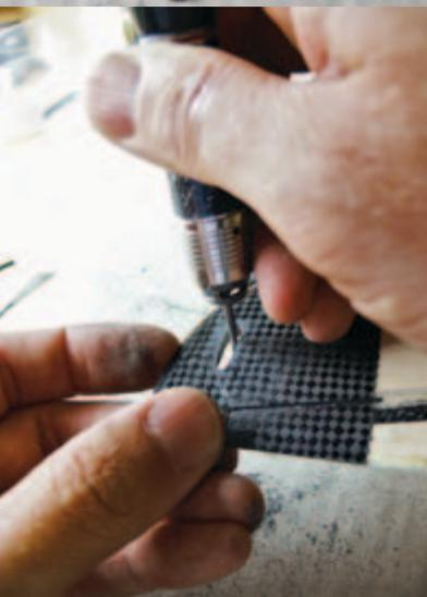
Auch die Leitwerksanlenkung wird durch Bindfaden und Sekundenkleber gesichert.
