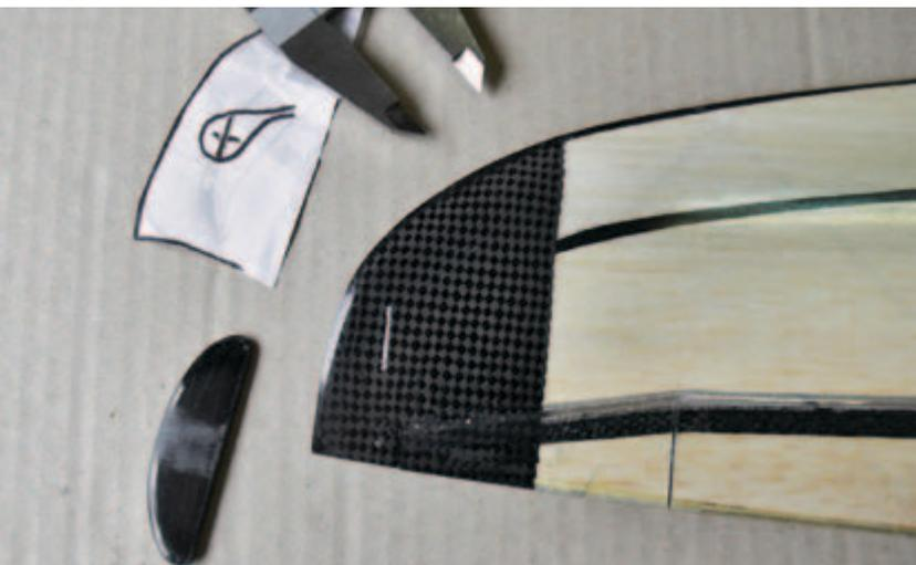
Die Position des Wurfblades wird mittels beiliegender Schablone übertragen und dann ausgefräst.
