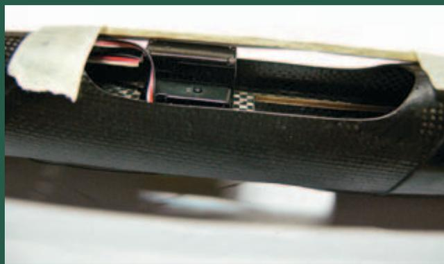
*Die RC-Komponenten: der Empfänger wird noch durch den mit zwei Antennen bestückten 4+2 ausgetauscht.*
