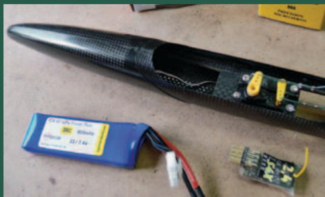
*Empfänger und Lade-/Einschaltbuchse verschwinden vorne im Rumpf, nur die beiden Antennen schauen heraus.*
