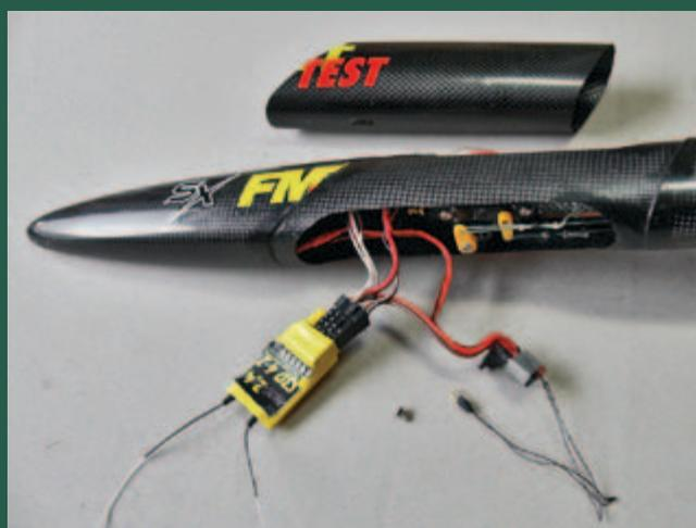
*Eine Aussparung zum elektrischen Anschluss der Flächenservos muss in der Auflage eingefräst werden.*
