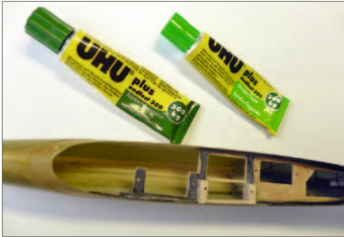
Das Servobrett wird kraftschlüssig mit einigen Rovings verstärkt.
