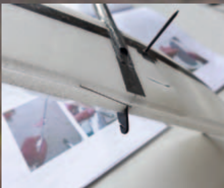
Das Seitenruder wird durch eine 0,5-mm-Stahl-torsionsfeder nach links gezogen.
